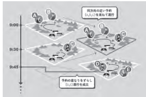
「TAKUZO」のイメージ。利用者の発着時間を少しずつズラしながら、タクシー1台での輸送人数を最大化し、運行コストを最小化する
